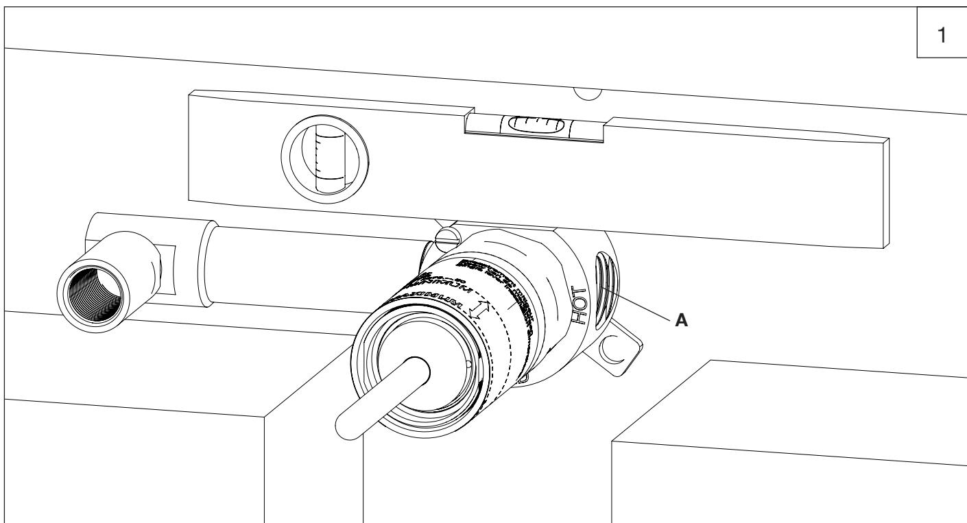
Ce robinet dispose d'un système permettant d'avancer ou reculer le mécanisme suivant votre encastrement.
